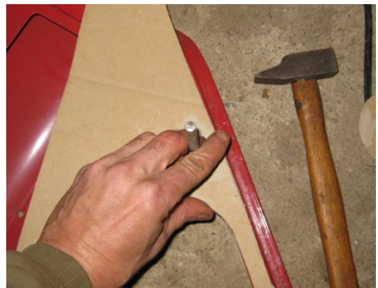
4 – Retourner et positionner le gabarit à l'intérieur de la porte droite et pointer le trou
