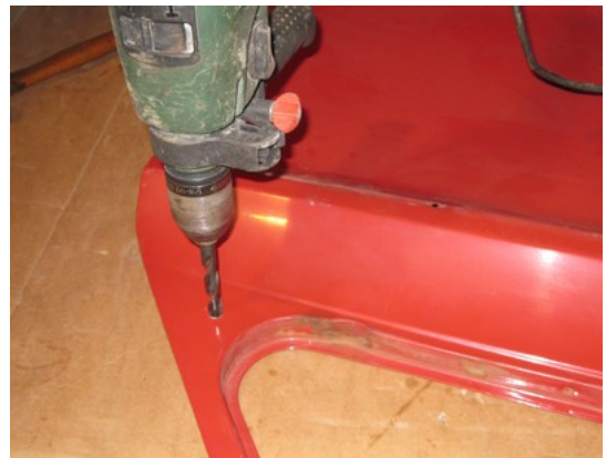
6 – Percer l'extérieur au diamètre 10 en se servant du trou de 5 pour le centrage
