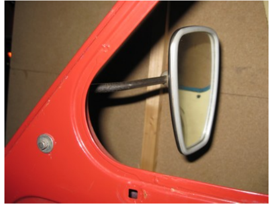
14 – Une tige droite serait préférable pour le réglage
